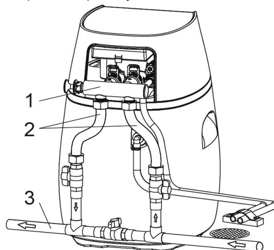
8.8 Подключите систему к водопроводной магистрали 3: руководствуясь стрелками на клапане управления и/или байпасном клапане, указывающими направление потока воды (вход и выход). Внимание! Не путать направление подключения, т.к. это приведет к нарушению работоспособности системы.
