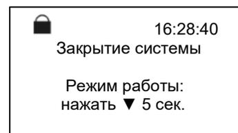
После устранения протечки и замены абсорбирующей губки (см. 19.3.2), нажмите и удерживайте кнопку  в течение 5 секунд, система перейдет в режим «Сервис».
